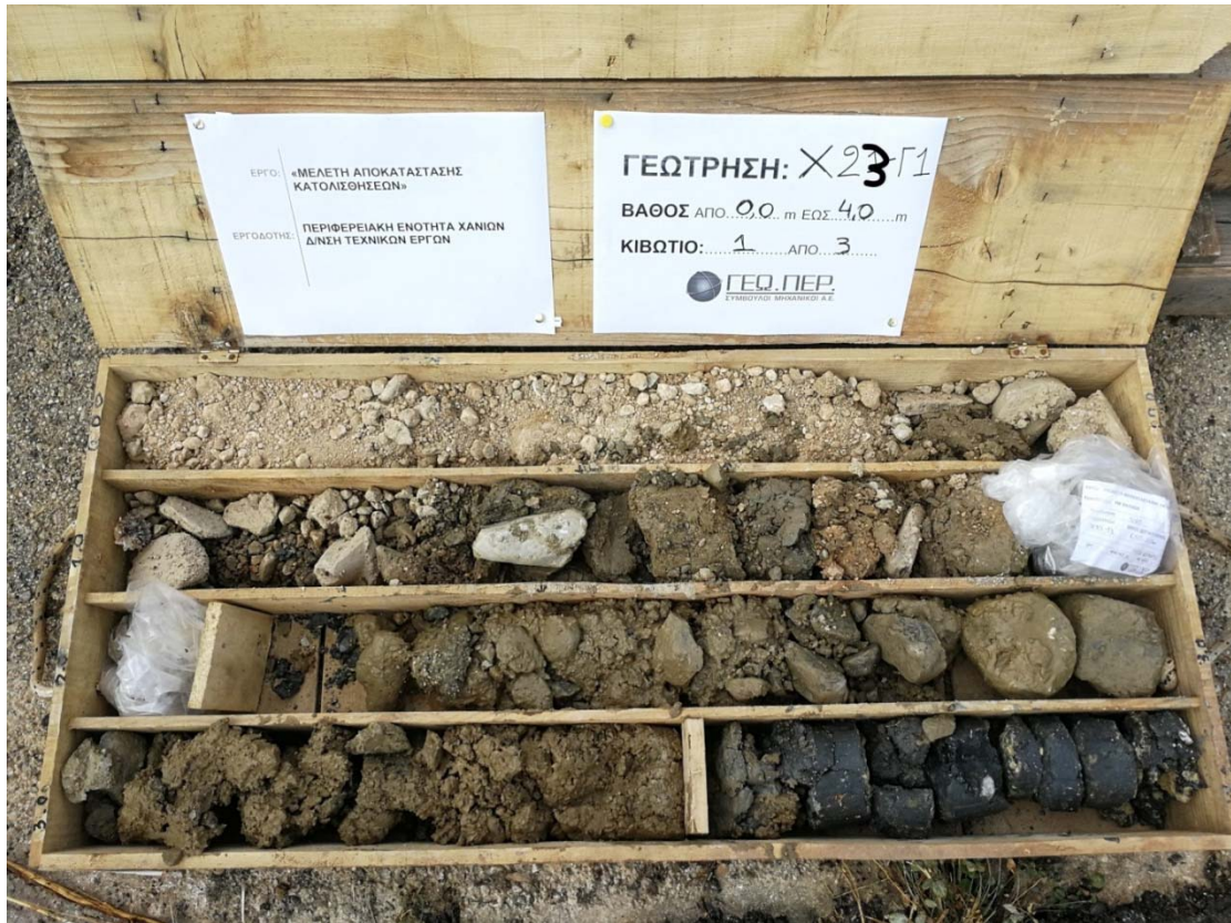
Φωτογραφία 5: Πυρηνοληψία γεώτρησης X23Π: βάθος 0,00 έως 4,00m
