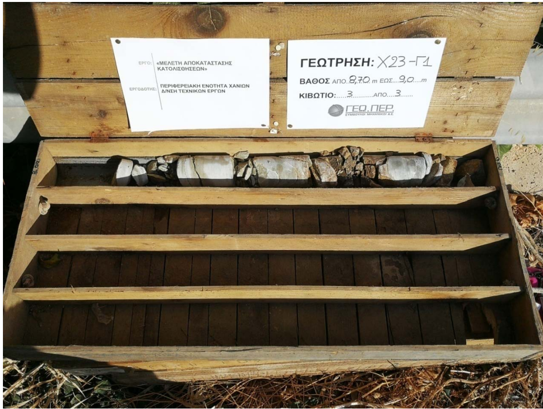
Φωτογραφία 7: Πυρηνοληψία γεώτρησης Χ23Π: βάθος 8,70m έως 9,0
