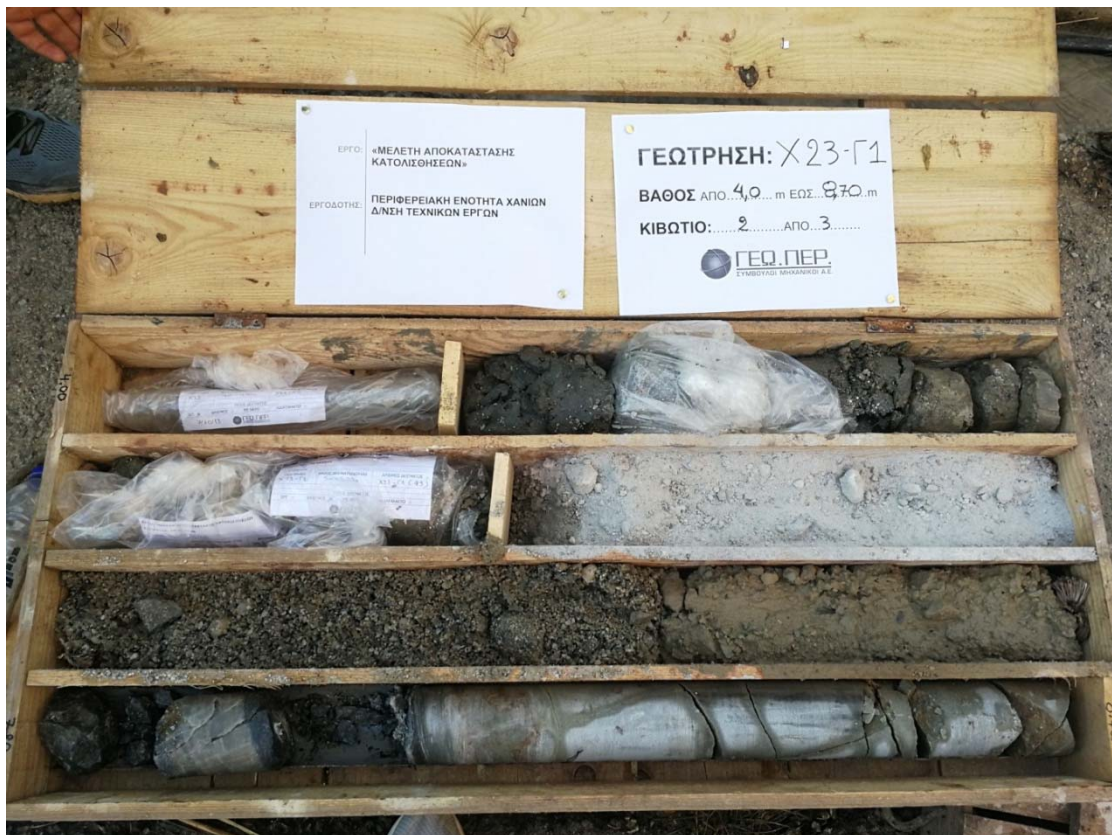
Φωτογραφία 6: Πυρηνοληψία γεώτρησης X23Π: βάθος 4,00 έως 8,70m
