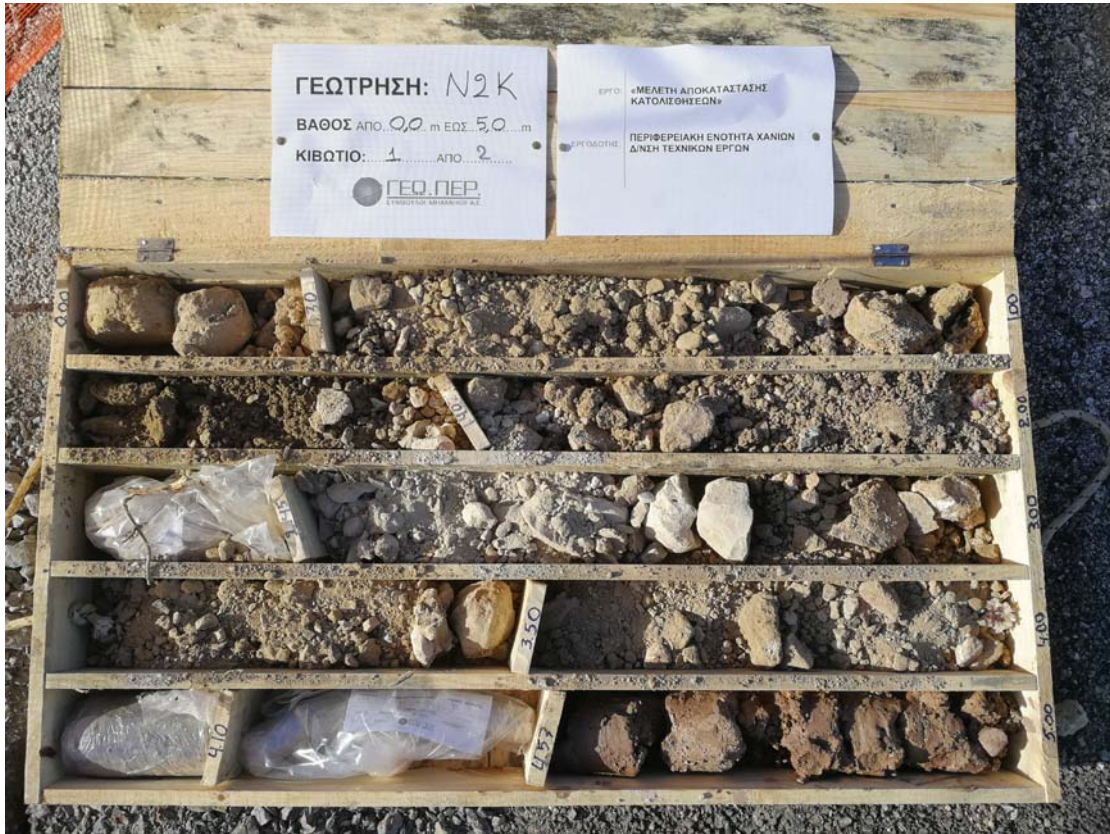
Φωτογραφία 2.: Γεώτρηση N2K, βάθος από 0,00m έως 5,00m
