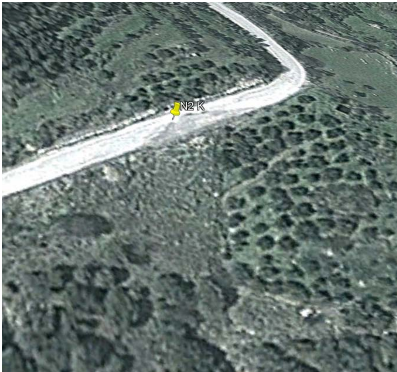
Εικόνα 2.3 - πηγή Google Earth. Λήψη 06/2013- Κατάρρευση επιχώματος της οδού.
