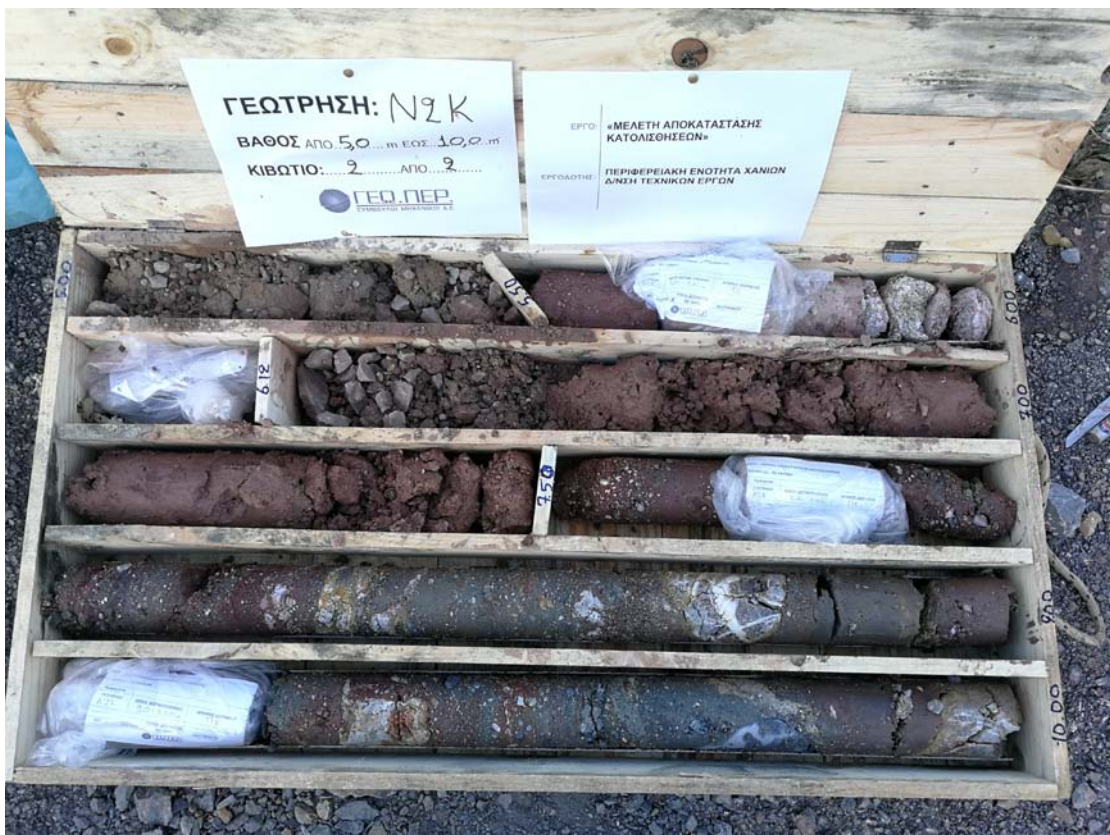
Φωτογραφία 3.: Γεώτρησης N2K, βάθος από 5,00m έως 10,00m
