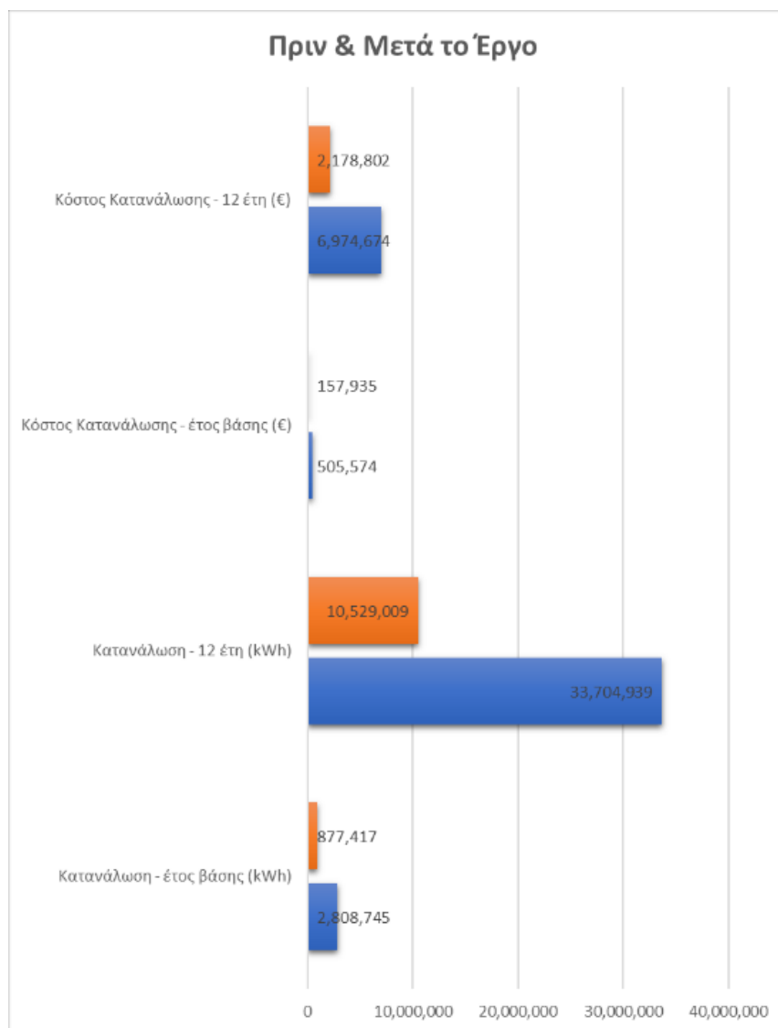
Εικόνα 1 – Πριν & Μετά το έργο ενεργειακής αναβάθμισης
