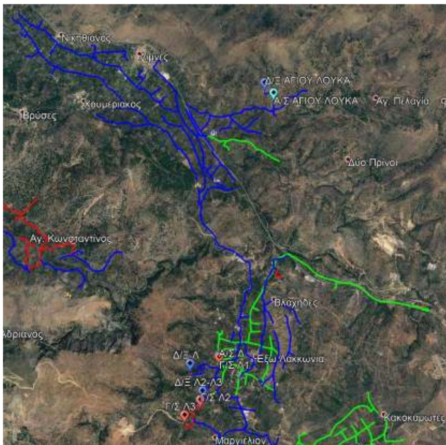
Οριζοντιογραφία δικτύου άρδευσης περιοχής Λιμνών Τ.Κ. Μέσα Λακωνίων και Τ.Κ. Έξω Λακωνίων
