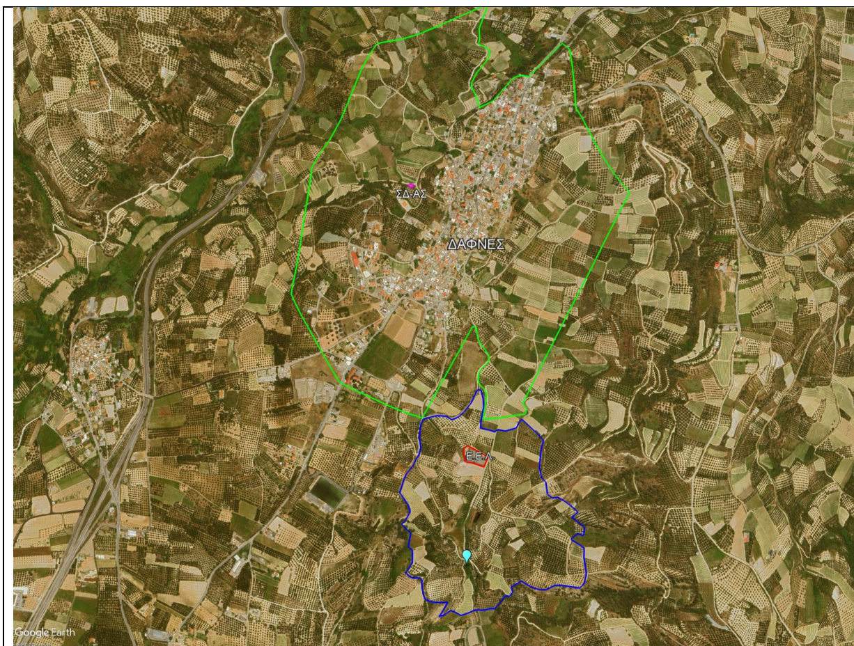
Εικ. 1: Στη δορυφορική εικόνα διακρίνεται η θέση της Ε.Ε.Λ. (με κόκκινο στο κέντρο), η θέση της σηπτικής δεξαμενής – αντλιοστασίου (με φούξια στα βόρεια), η θέση διάθεσης στο ρέμα (με γαλάζιο νότια της Ε.Ε.Λ.), η περιοχή άρδευσης (με μπλε περιμετρικά της Ε.Ε.Λ.), καθώς και ο οικισμός των Δαφνών (με πράσινο βόρεια της Ε.Ε.Λ.).
