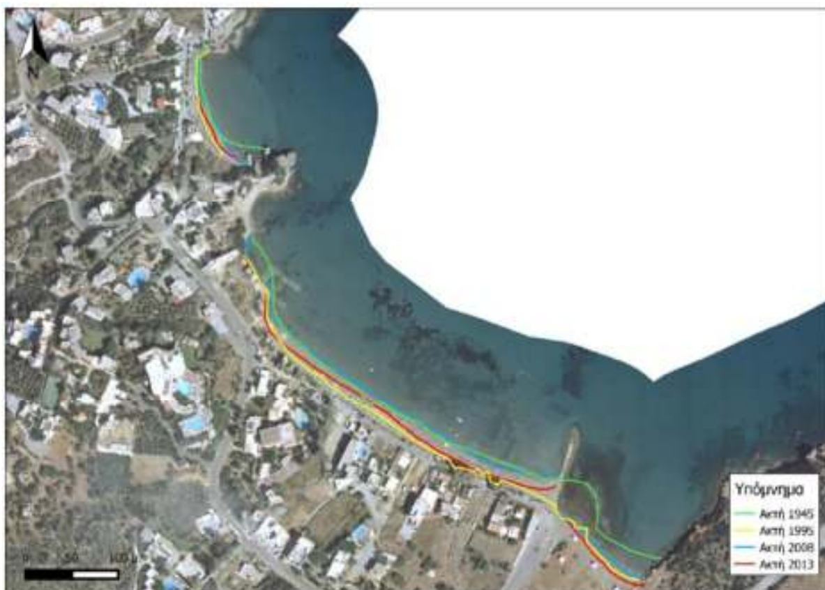
Εικόνα 2: Αεροφωτογραφία του 2008 με την ακτογραμμή τα έτη 1945, 1995, 2008 και 2013.
