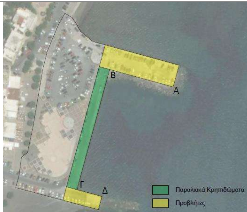
Εικόνα των Λιμενικών έργων έμπροσθεν Δημοτικού Parking
